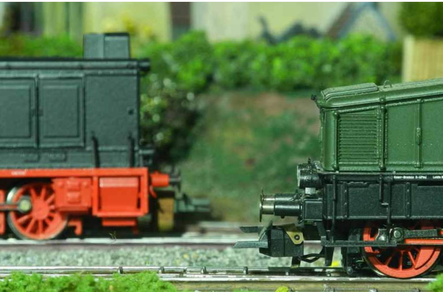
Bei der E 60 von Fleischmann mit Kreis-Kupplung ist deren Abstand zu den Pukos der K-Weiche deutlich. Dahinter eine V 36 mit Original-Roco-Kupplung.
