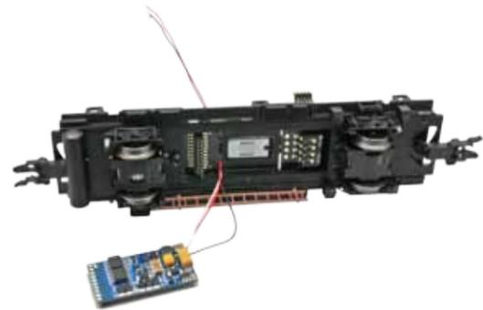
Die Kabel zum PowerPack müssen an der der Schnittstelle gegenüberliegenden Kante des Decoders angeschlossen werden.
