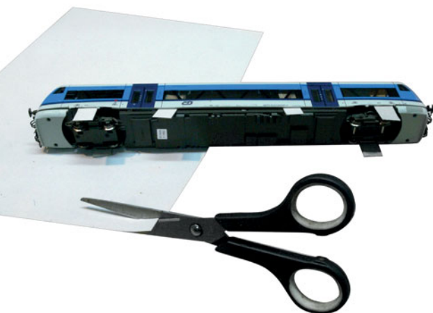
Aus einem Streifen Pappe entsteht der Halter der Innenbeleuchtung.
