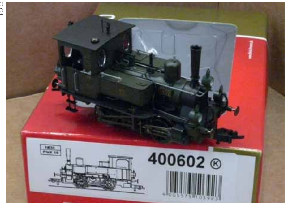
Nur eine Handvoll Lok: Fleischmanns gelungene D VI gehört zu den kleinsten H0-Triebfahrzeugen. Mit etwas Fleiß kann sie problemlos auf Mittelleiter-Wechselstrombetrieb umgebaut werden. Links die mit einem Brawa-Schleifer ausgestattete Lok auf Märklin-C-Gleis (FOTO CHRISTOPH KUTTER).
