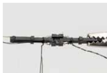
Der um den Kupplungsschaft gewickelte Draht sichert die Anschlüsse mechanisch.
