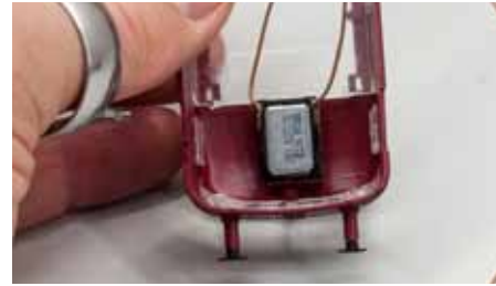
Der Lautsprecher ist an seinem endgültigen Platz eingeklebt.
