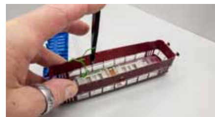
Gleichzeitiges Spreizen und Entriegeln löst die Scheiben.
