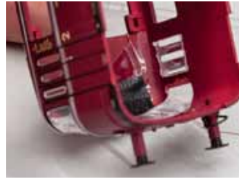
Die direkt eingeklebten Scheiben lassen viel freien Raum im Dachbereich.
