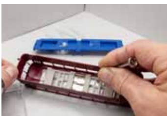
Das Zerlegen geht weiter, bis man an die Lichtleiter gelangt.
