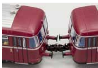
Die neue Kupplung in eingebautem Zustand.
