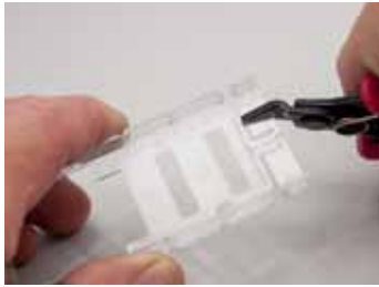
Die Scheiben der Türen werden vom durchsichtigen „Glas“-Einsatz abgetrennt.
