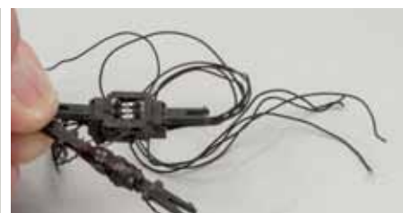
Vorne die Selbstbau-, hinten die Kreis-Kupplung im Vergleich.
