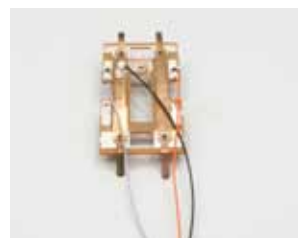
Die Schleiferplatine erhält neue Kabel.
