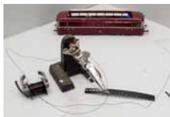
Insgesamt werden sechs rot/weiße und drei warmweiße LEDs mit recyceltem Spulendraht versehen.
