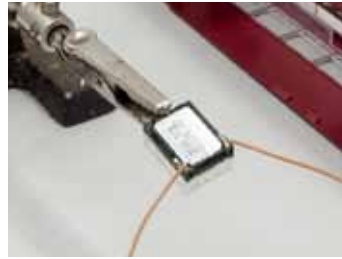
Durch den direkten Kabelanschluss wird der Decoder so klein, dass er ins Dach über einen Führerstand passt.
