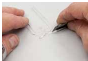
Man schneidet die Enden der Lichtleiter ab und füllt mit ihnen die Lampenlöcher im Gehäuse.
