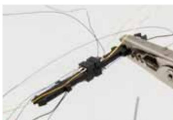
Stück für Stück werden die Steckkontakte bestückt.
